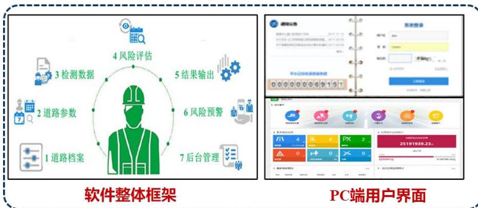
城市道路坍塌脱空安全评估软件
